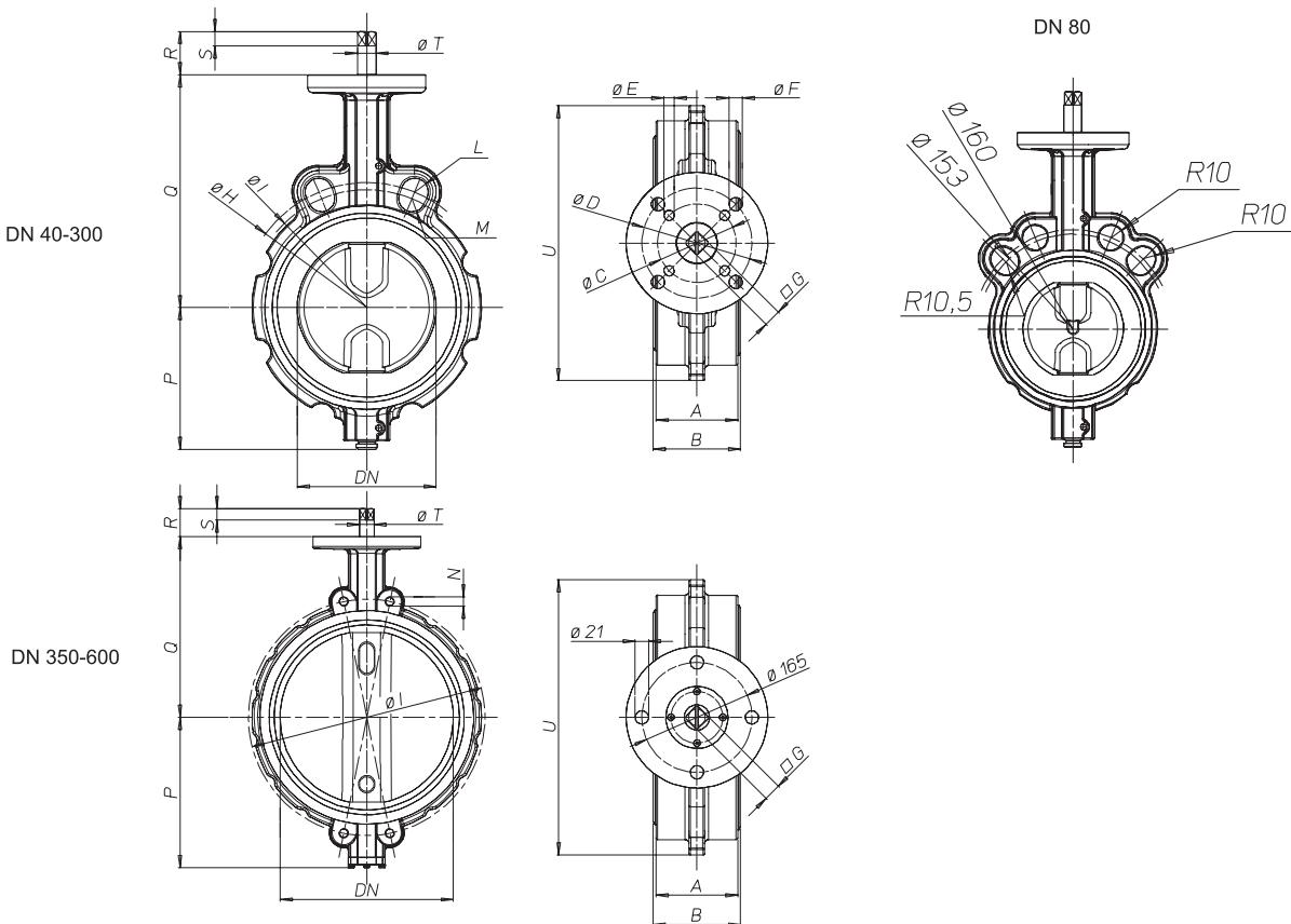
G' - для затворов с пневматическим приводом PN10
