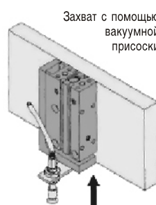
Монтаж на боковой стенке (через корпус)
