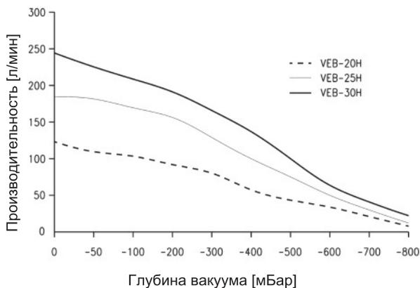
Зависимость производительности от глубины вакуума
