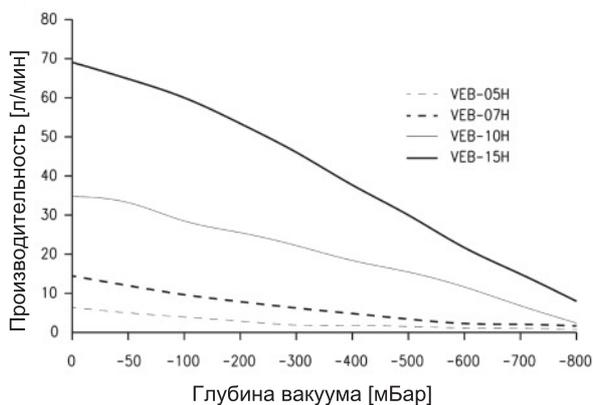
Зависимость производительности от глубины вакуума
