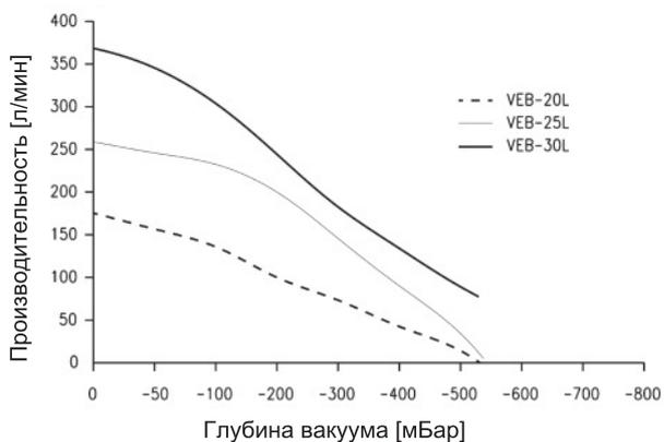
Зависимость производительности от глубины вакуума
