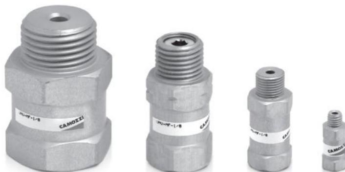
Запорные клапаны Серии VNV в основном используются в системах, содержащих несколько присосок для уменьшения расхода через те из них, которые не соприкасаются с изделием. При использовании запорных клапанов система поддерживает необходимую глубину вакуума и корректную работу вакуумного коллектора.
