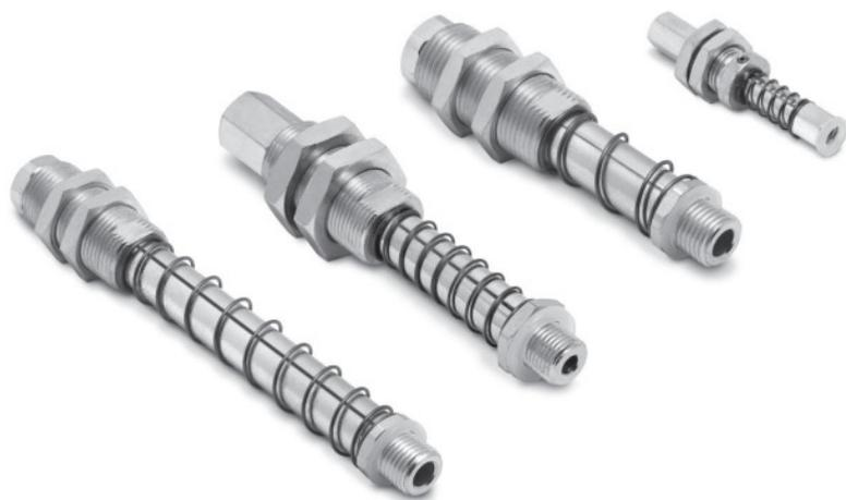
Пружинные плунжеры используются в случаях, когда необходимо компенсировать изменяющуюся высоту деталей. Пружина также обеспечивает мягкий прижим присоски к детали, исключая дальнейший контроль в полностью автоматизированных системах, что особенно важно при работе с хрупкими деталями.
