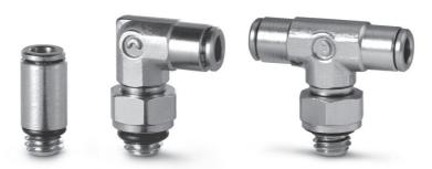
Быстроразъемные соединения Серия 6000 "МИКРО" включают в себя 14 разных моделей. Присоединение и разъединение трубки может повторяться несколько раз и выполняется вручную, без использования инструментов. Уплотнительное кольцо легко заменяется в случае повреждения или износа.
