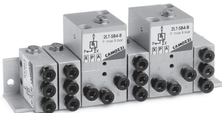
Логические элементы Серии 2L обеспечивают следующие функции: “ДА”, “НЕТ”, “ИЛИ”, “И” и “ПАМЯТЬ”. Они могут быть смонтированы как отдельно через два отверстия в корпусе, так и совместно на специальной скобе мод. 2LQ8A. Скоба мод. 2LQ8A разработана так, что присоединительные отверстия логических элементов расположены в передней части для упрощения присоединения трубок.
