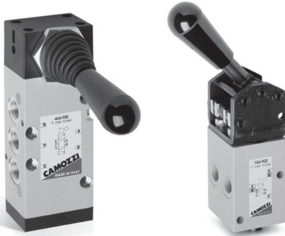
Распределители с ручным управлением Серия 3 (G1/8, 3/2 и 5/2-лин/поз.) и Серия 4 (G1/4, G1/2, 3/2, 5/2 и 5/3-лин/поз.) имеют различные переключатели: фиксируемая и подпружиненная кнопка, кнопка-грибок, прямой и боковой тумблер, рычаг. Распределители 3/2-лин/поз. (Серия 3 и 4) могут подключаться по схеме Н.З. и Н.О. При подаче давления в отверстие Р распределитель работает как нормально закрытый.
