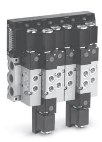
Plug-In система основана на использовании электропневматических распределителей Серии 3 с присоединением G1/8, поставляется полностью собранной и протестированной, может включает в себя до 22 распределителей (с двумя SUB-D разъемами). Класс защиты IP65.
