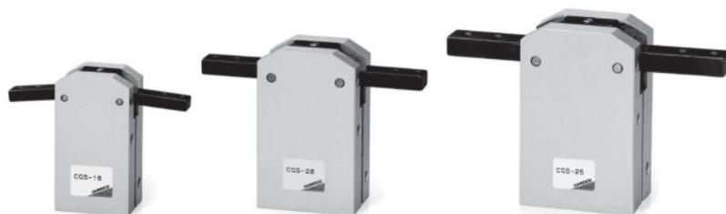
Схваты серии CGS 4-х типоразмеров раскрываются на 180°, что позволяет захватывать необходимые объекты, избегая столкновения губок с другими элементами. Это позволяет сократить необходимое количество движений манипулятора. Многозвенный механизм обеспечивает увеличение усилия захвата. Поршень оснащен магнитным кольцом для работы с датчиками положения мод. CSB.
