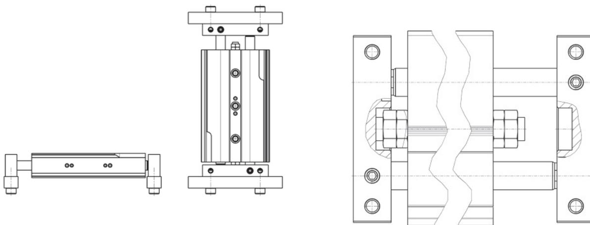
Передний и задний настроечные винты позволяют регулировать ход в диапазоне до 10 мм.
