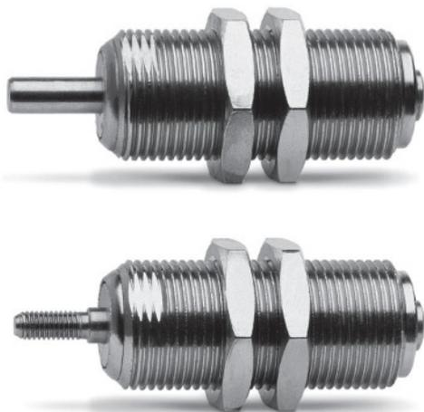
Компактные миницилиндры Серии 14 одностороннего действия с пружинным возвратом предназначены для монтажа в ограниченном пространстве. Конструкция цилиндров позволяет собирать их в блоки или вворачивать непосредственно в несущие элементы конструкции.
