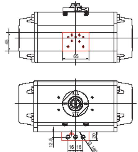
Плита **ISO** необходима для всех моделей приводов, если требуется присоединить соленоидный клапан со стыковой поверхностью, выполненной по **ISO 5599/1**
